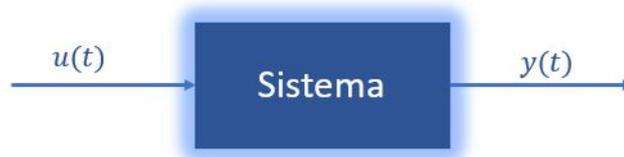
Figura 2.1 – Diagrama de blocos de um sistema simplificado.  $u(t)$  corresponde ao sinal de entrada do sistema. Por consequência, há um sinal  $y(t)$  gerado na saída.
