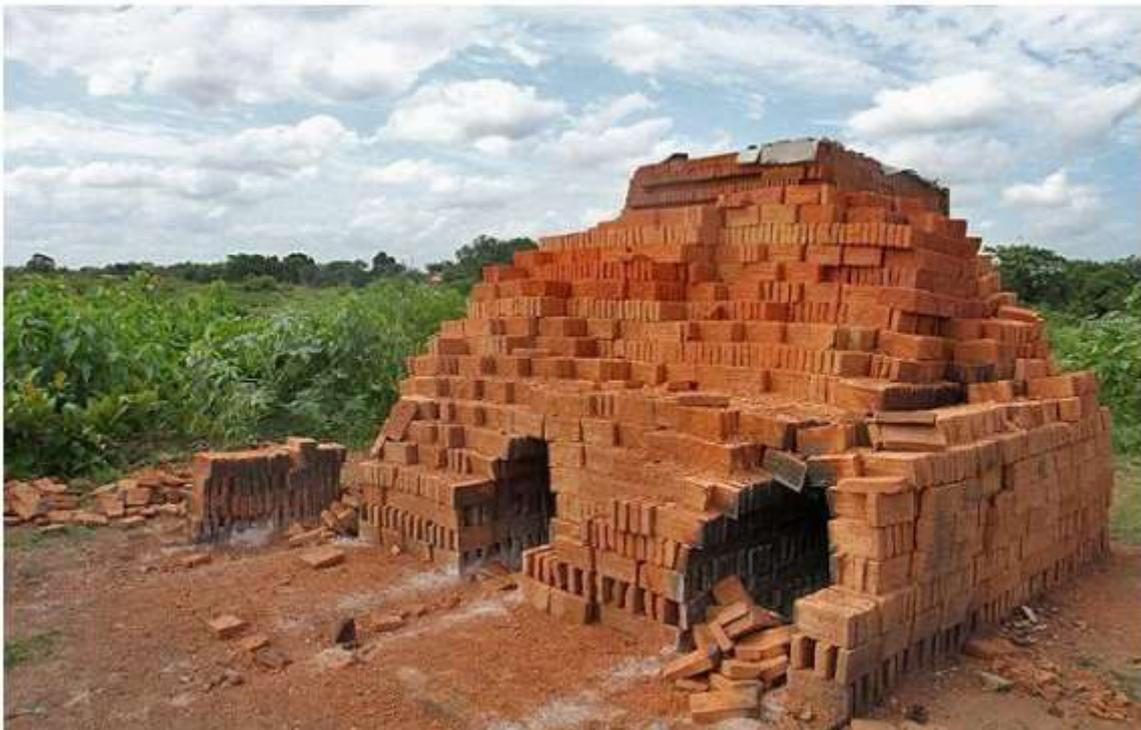
**Figura 7.** Forno de produção de tijolos na olaria.
