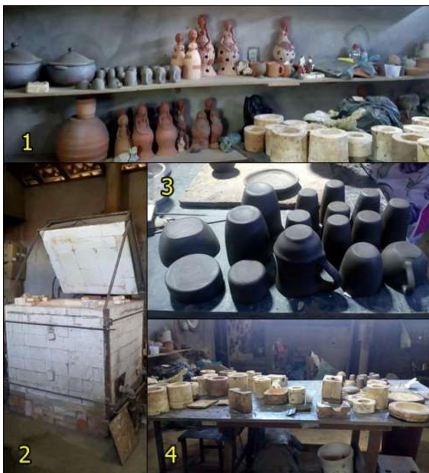
**Figura 22.** Oficina de trabalho da COOPERART-Poty – 1) Peças já queimadas em processo de finalização. 2) Forno para queimar as cerâmicas. 3) Peças recém modeladas. 4) Moldes para fabricação de utensílios.
