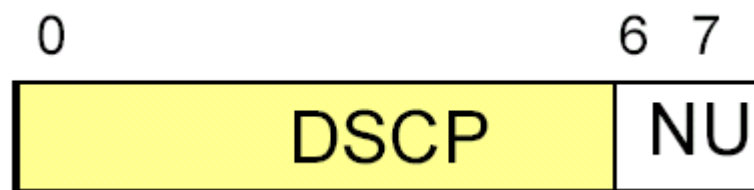
Figura 2-2 – Campo DS do cabeçalho IPv4, definido pela RFC 2474.
