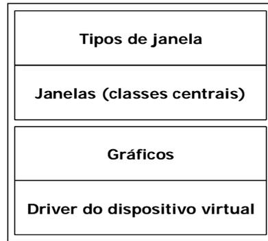
Figura 8. Estrutura de projeto de um sistema de administração de janelas
