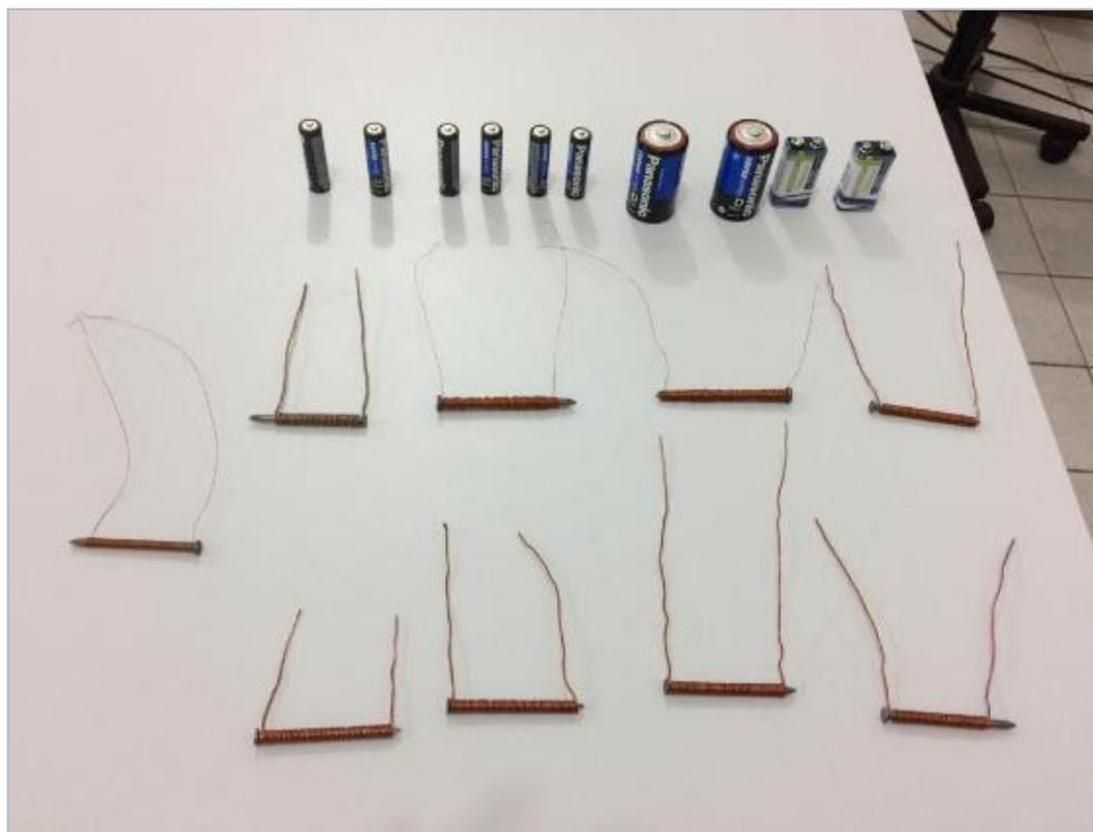
Seguindo o roteiro, o próximo passo foi lixar as extremidades livres dos solenoides, para ocasionar um melhor contato dos fios com os terminais da fonte, para logo após, ligá-los aos polos da pilha. Com o eletroímã construído, foi feita a aproximação a pequenos objetos metálicos para a observação da atração magnética, conforme as Figuras 20 a 23.
