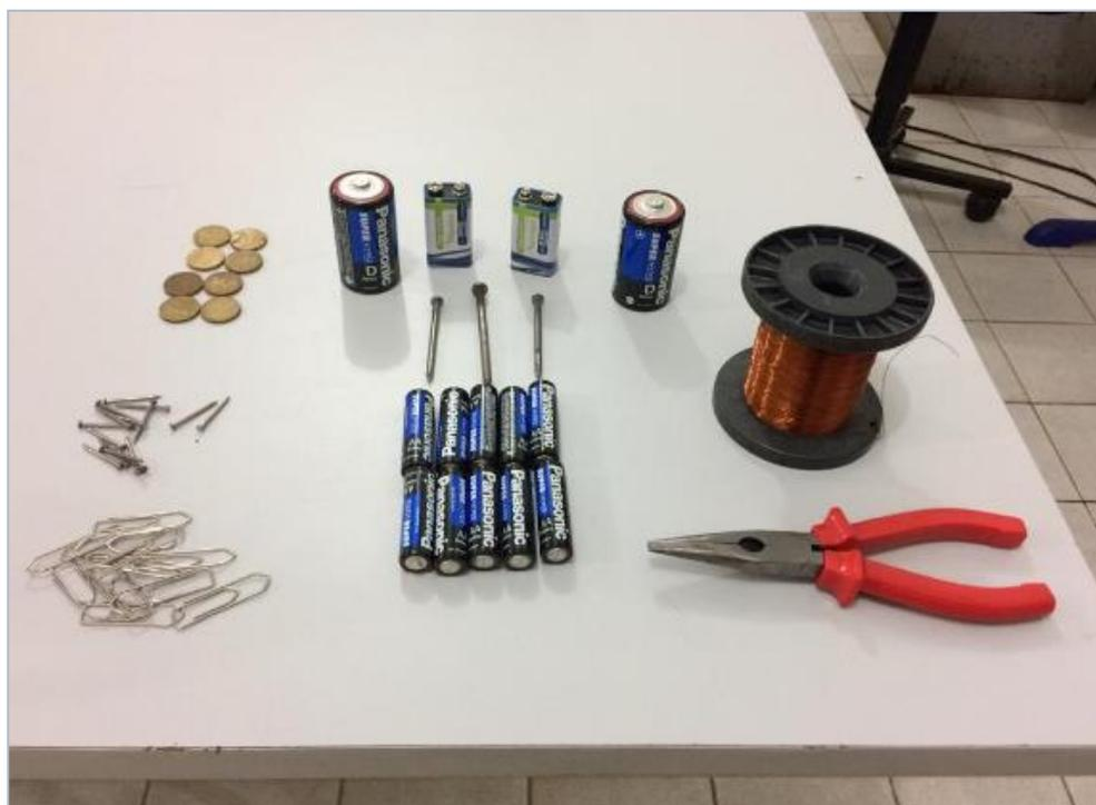
Seguindo os procedimentos sugeridos pelo roteiro de atividades, os alunos começaram a preparar os solenoides, enrolando o fio de cobre em torno do prego, de uma maneira que fosse fácil retirar o prego do interior do solenoide e recolocá-lo quando necessário, conforme Figura 19.
