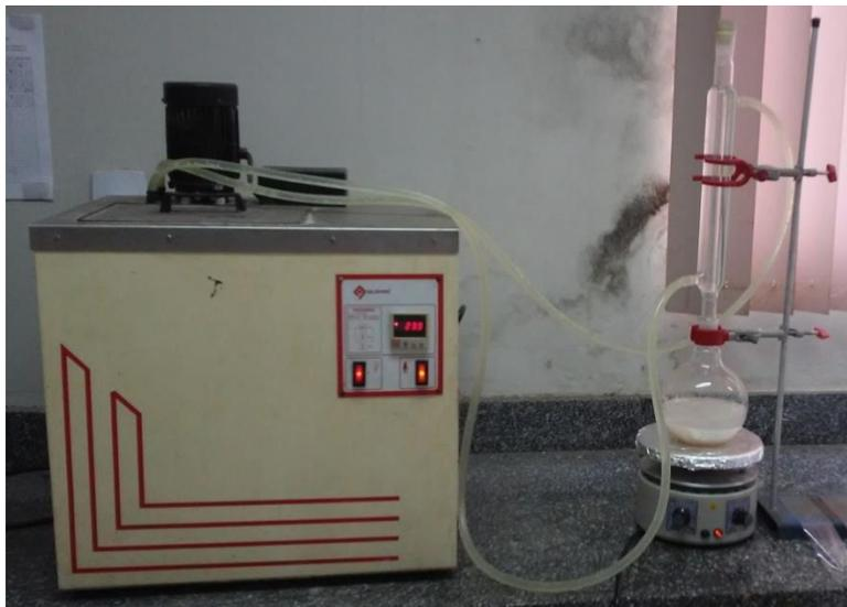
**Figura 5.** A desacetilação da quitina com hidróxido de sódio 50 %, na proporção de 20 mLg<sup>-1</sup> sob refluxo.
