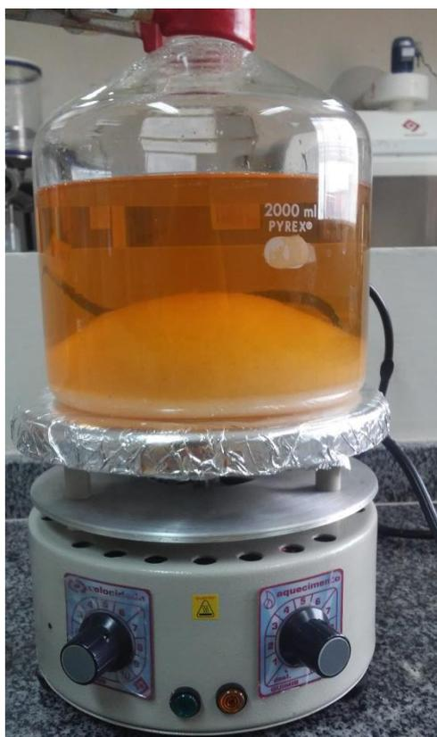
**Figura 3.** Desproteíntização das cascas de camarão com hidróxido de sódio  $1 \text{ molL}^{-1}$ , na proporção de  $20 \text{ mLg}^{-1}$ .
