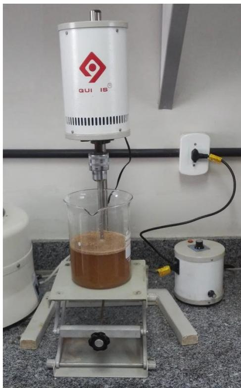
**Figura 2.** Desmineralização das cascas de camarão com ácido clorídrico  $0,25 \text{ molL}^{-1}$  na proporção de  $40 \text{ mLg}^{-1}$ .
