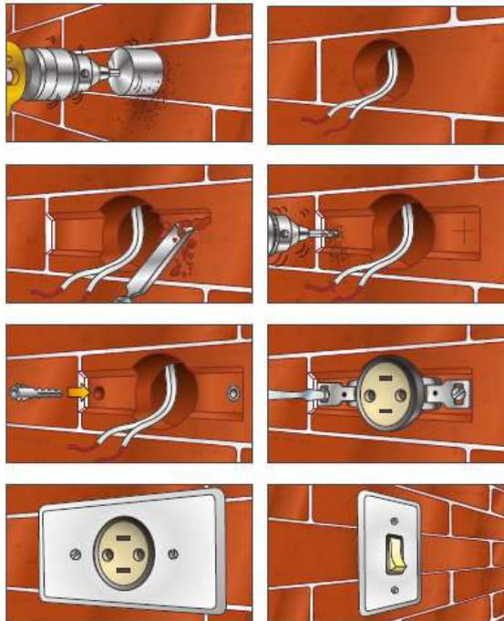
Figura 14: Instalações elétricas em tijolos de solo-cimento.
