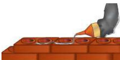
Figura 04: Assentamento dos tijolos de solo-cimento.
