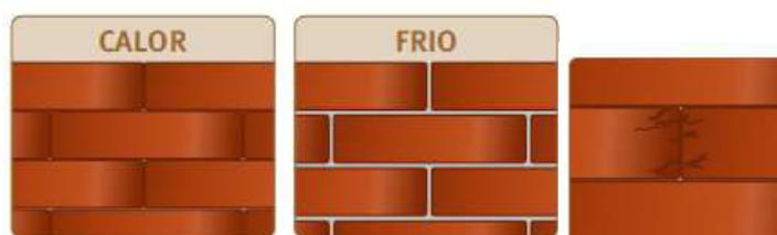
Figura 05: Dilatação dos tijolos de solo-cimento.
