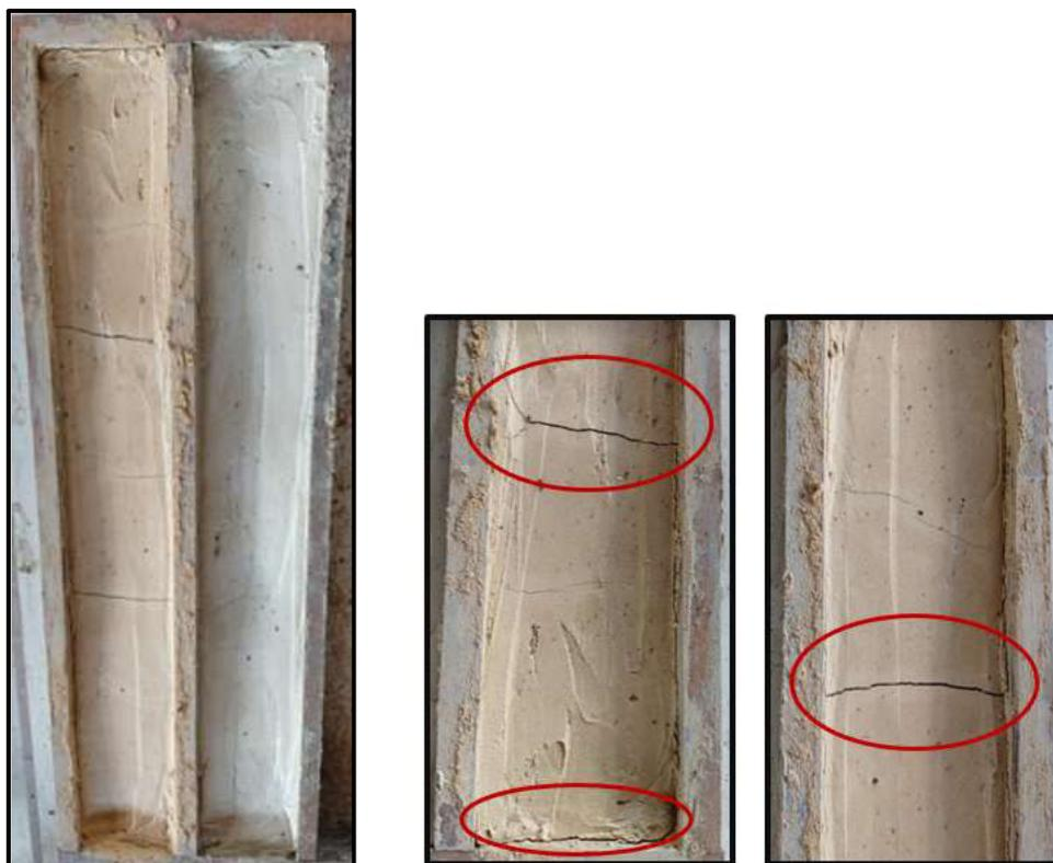
Figura 30: Teste de retração em mistura solo-cimento.
