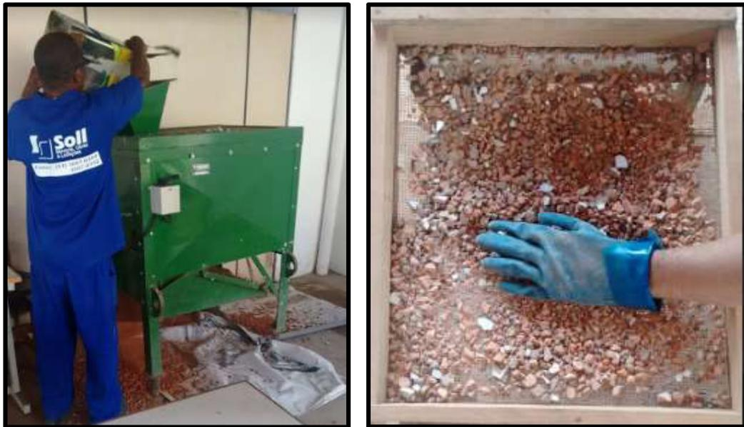
Figura 20: Trituração e Limpeza do RCD.
