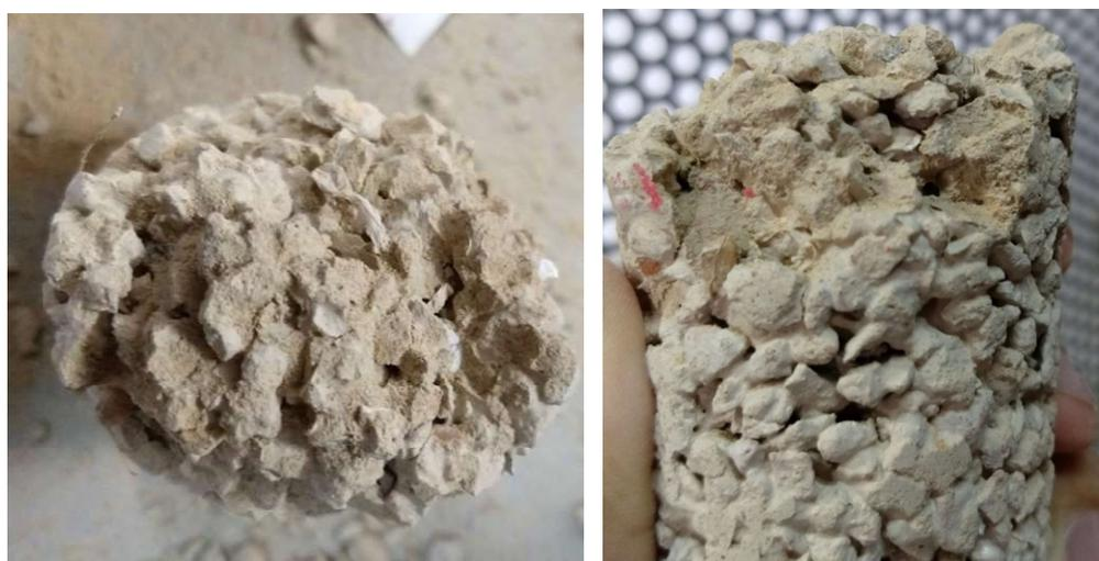
Figura 32: Corpo de prova poroso após ruptura.
