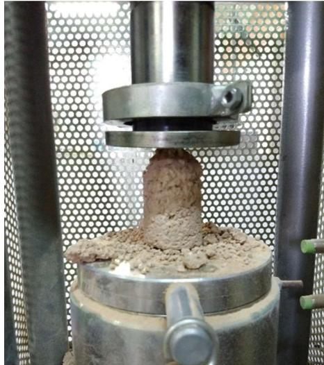
Figura 33: Corpo de prova do Solo 02 denominado P7.60 após ruptura.
