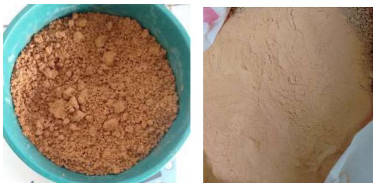
Figura 18: Destorroamento do solo.
