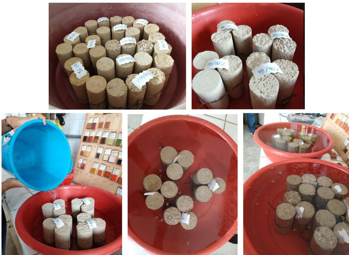
Figura 28: Preparação do ensaio de absorção.
