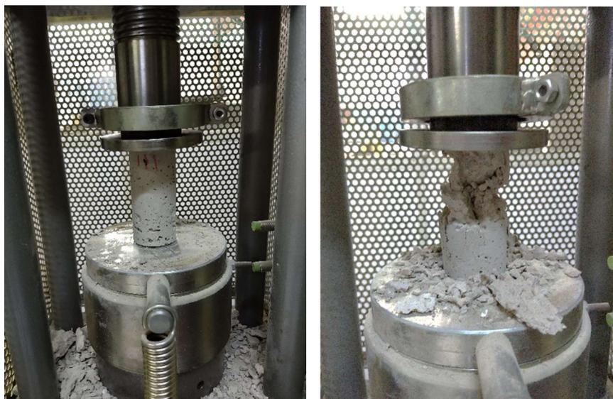
Figura 31: Ruptura do corpo de prova com maior resistência (P7.40).
