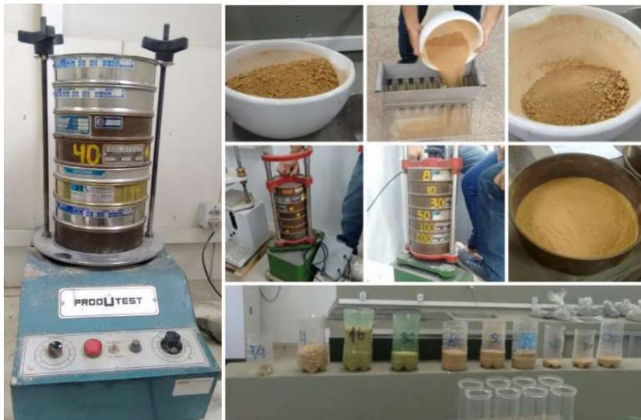
Figura 19: Ensaio de peneiramento - série de peneiras padronizadas e aparelho elétrico de peneiramento.
