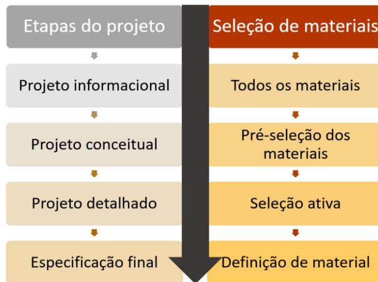
Figura 7: Seleção de materiais no Processo de Desenvolvimento de Produtos.
