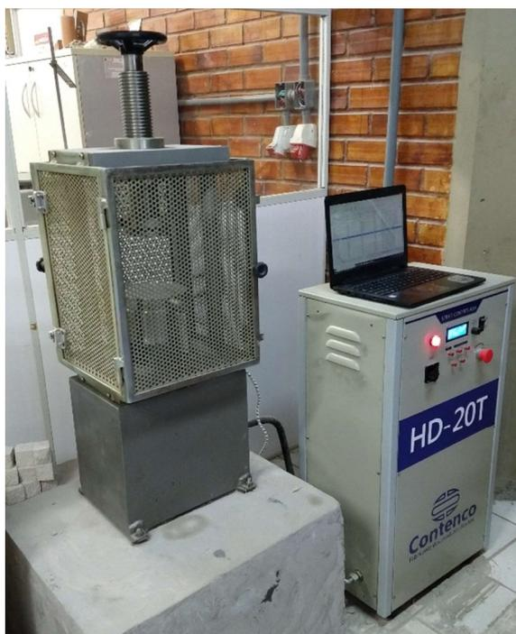
Figura 27: Equipamento para ensaio de compressão.
