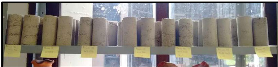
Figura 26: Corpos de prova em processo de cura.
