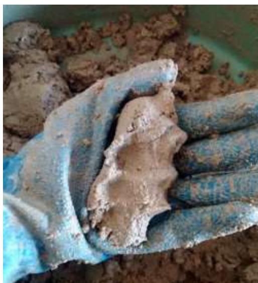
Figura 23: Teste visual e manual da massa.
