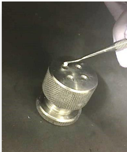
Figura 2: Confeção de espécimes para avaliar microdureza de Knoop de cada material.
