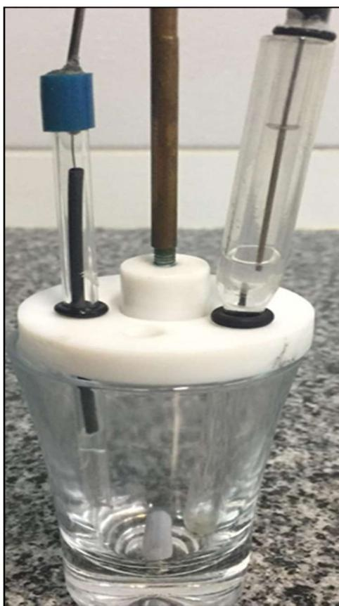
**Figura 5** - Célula Eletroquímica com entrada para três eletrodos (Fonte: próprio autor)
