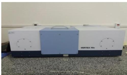
**Figura 27** – Espectrômetro Vertex 70v da *Bruker*. (Laboratório de Espectroscopia Ótica e Fototérmica II-(LEOF II)-UFMA).
