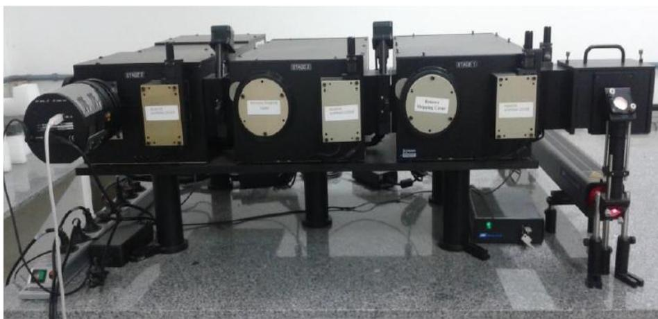
**Figura 19** – Espectrômetro triplo Trivista 557 da *Princeton Instruments* (Laboratório de Espectroscopia Raman- (LER)- UFMA).
