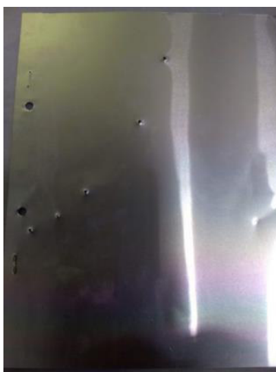
Figura 35 - Chapa de offset marcada
