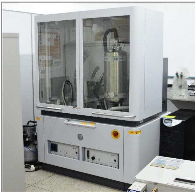
**Figura 21** - Difratorômetro PANalytical EMPYREAN equipado com câmara de temperatura TTK-450
