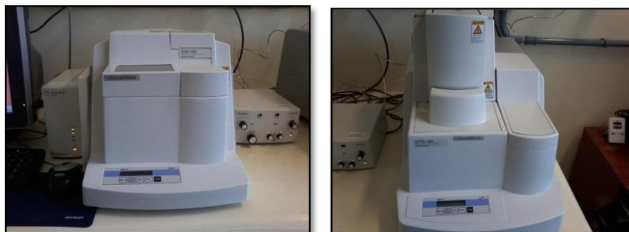
**Figura 22** - DSC 60 e DTG 60 Shimadzu, respectivamente.
