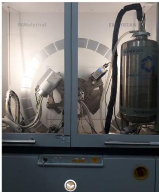
**Figura 20.** Foto do difratômetro em função da temperatura marca PANalytical modelo *Empyrean*.
