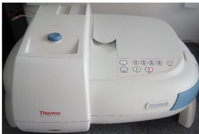
**Figura 14.** Foto do espectrofotômetro UV-Vis marca Thermo modelo *Evolution 220*.
