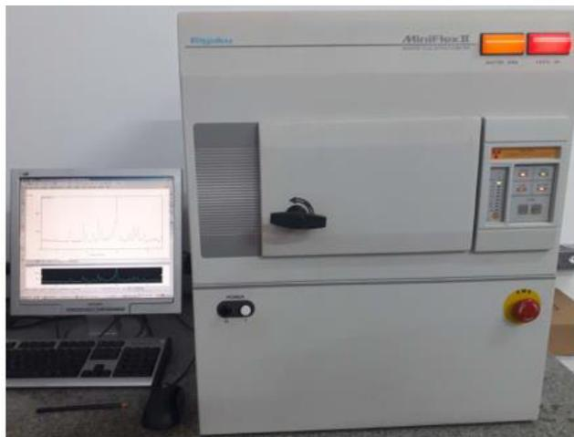
**Figura 15.** Foto do difratômetro marca Rigaku modelo *Miniflex II*.
