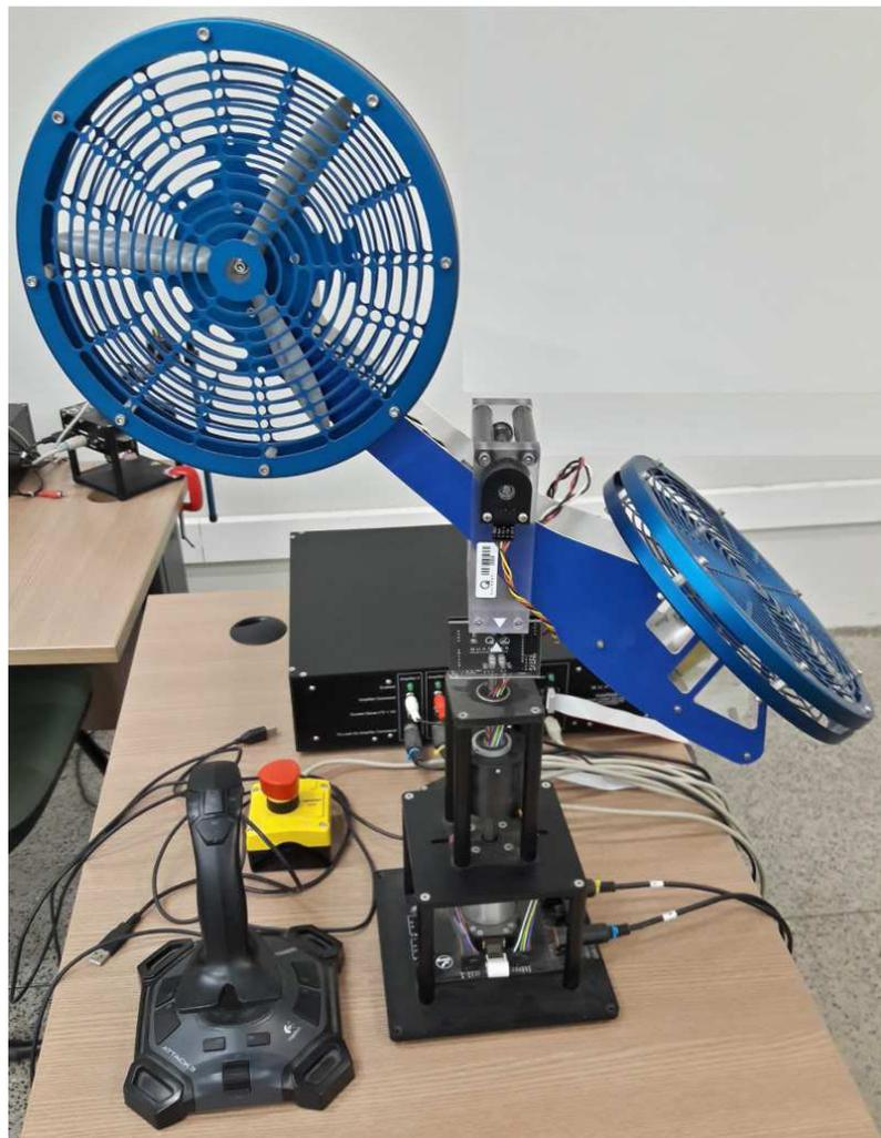
Figura 52 – Helicóptero 2DoF (FILHO; SERRA, 2016).
