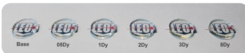
**Figura 32.** Fotografia de fatias das amostras após etapas de corte e polimento óptico.
