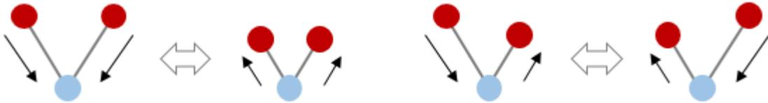
**Figura 22.** Representação do modo de vibração tipo *Stretching* (deformações axiais).
