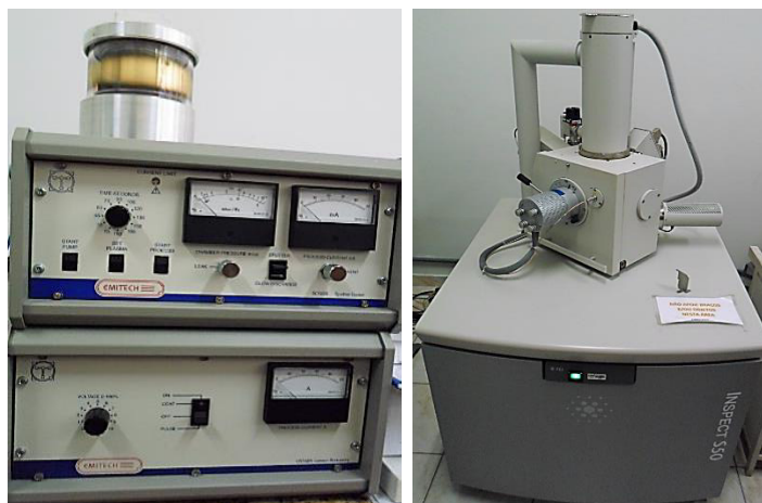
Figura 21: Metalizadora utilizada para aplicação de ouro nos espécimes (Desk II - Denton Vacuum, Moorestown, New Jersey, EUA). E Microscópio eletrônico de varredura (JMS 5310 – Jeol Brasil Instrumentos Científicos Ltda. – SP, BR)
