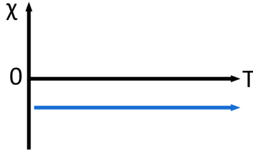
Figura 2 – Susceptibilidade magnética em função da temperatura para materiais diamagnéticos. Fonte: Referencia [54].
