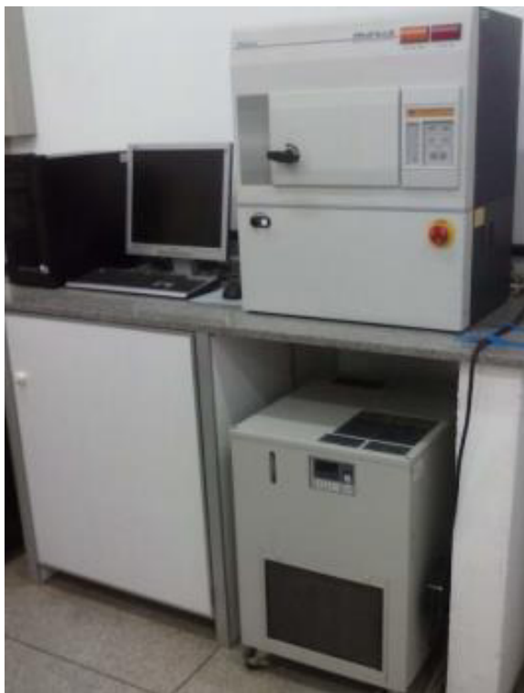
Figura 15 – Difratorômetro Rigaku MiniFlex II, modelo 4053-A, utilizado nas análises de difração de Raios X. Fonte: O próprio autor.
