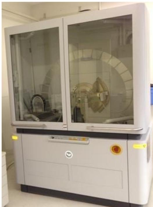
**Figura 16** - Difratômetro de raios X da marca PANalytical, modelo Empyrean, utilizado nas medidas de DRX com temperatura.
