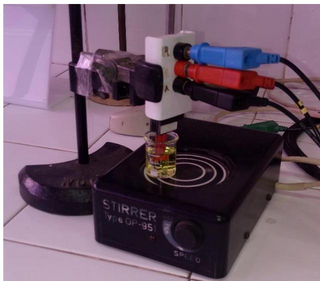
Figura 1: Biossensor de FRT aplicado em potenciostato e imerso em solução previamente preparada.
