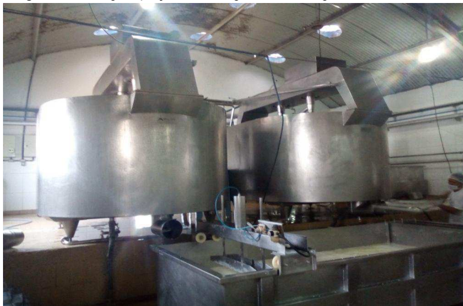
Imagem 05 – Tanque Queijomatics acopladas à Drenoprensa.
