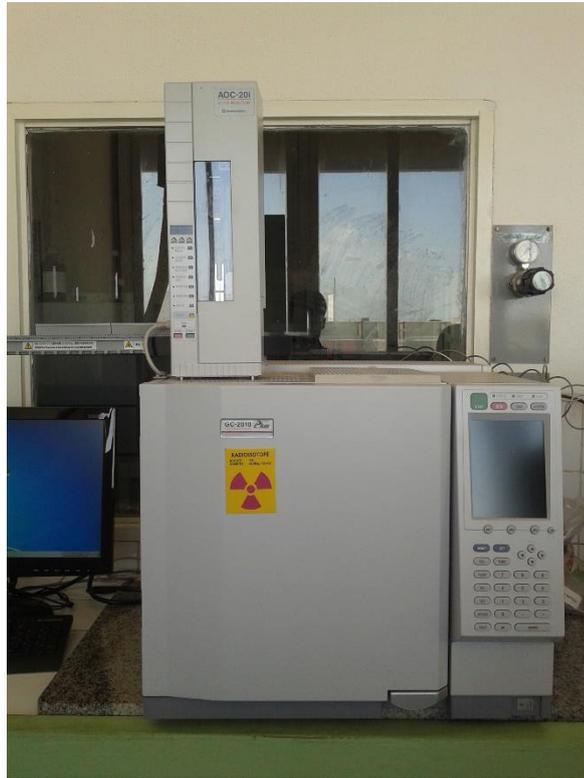
**Foto 1.** Cromatógrafo a gás (GC-ECD, Shimadzu, modelo 2010 Plus) do Núcleo de Análise de Resíduos de Pesticidas (UFMA/CCET).
