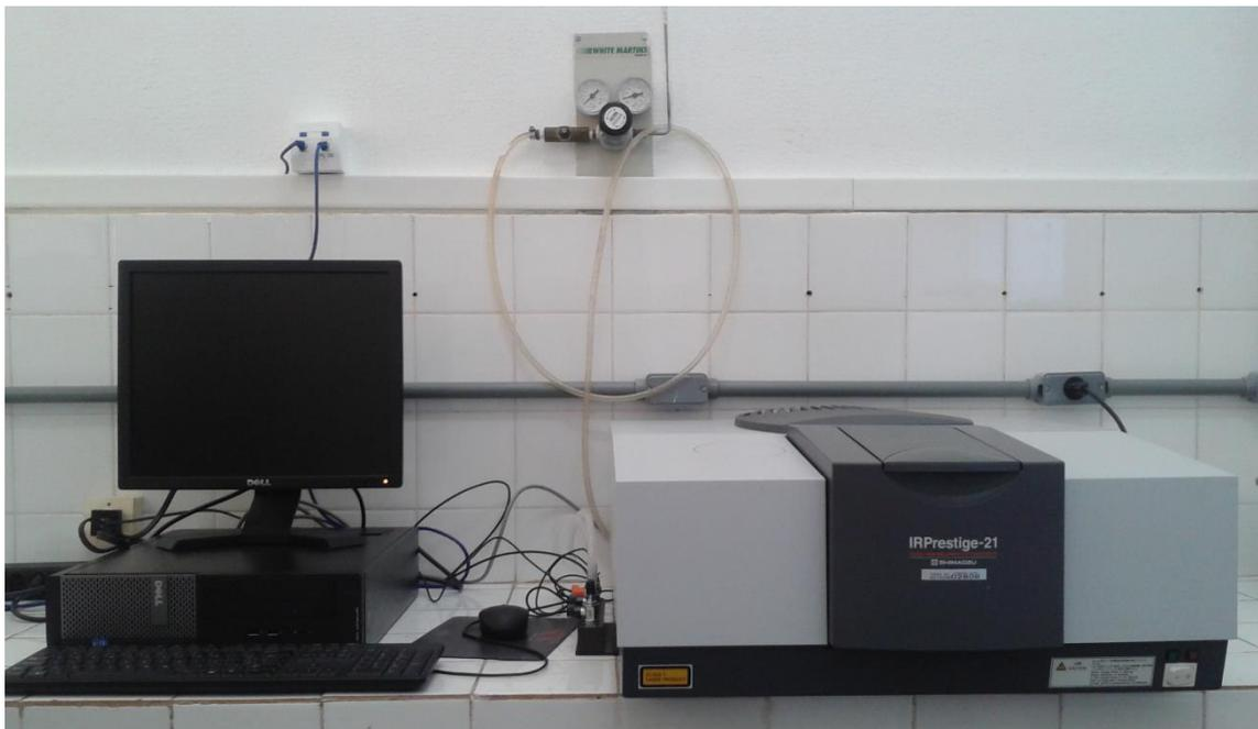
**Foto 2.** Espectrofotômetro de Infravermelho por Transformada de Fourier (FTIR Prestige 21, Shimadzu) do Laboratório de Central Analítica (CCET/UFMA).
