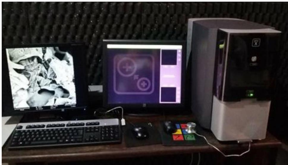
**Foto 4.** Microscópio Eletrônico de Varredura (MEV, Phenom World, modelo Pro X), do Núcleo de Combustíveis, Catálise e Ambiental – NCCA (CCET/UFMA).
