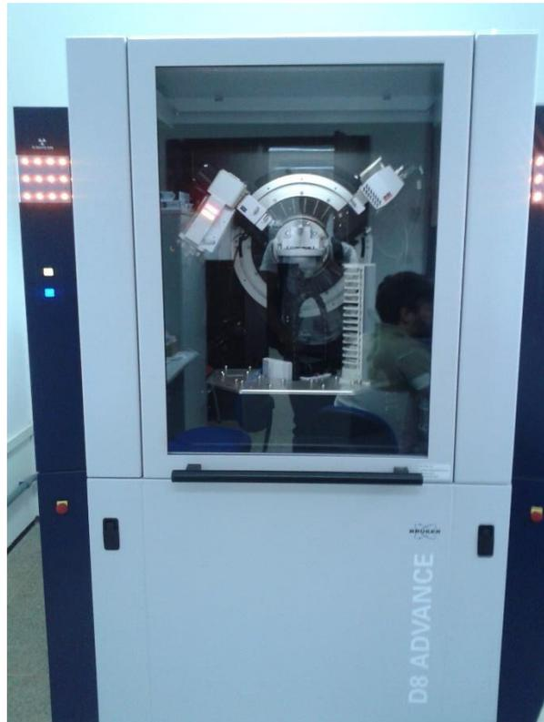
**Foto 3.** Difratorômetro de Raios-X (Bruker, modelo D8 Advance Lamult), do Laboratório de Central Analítica de Materiais (UFMA).
