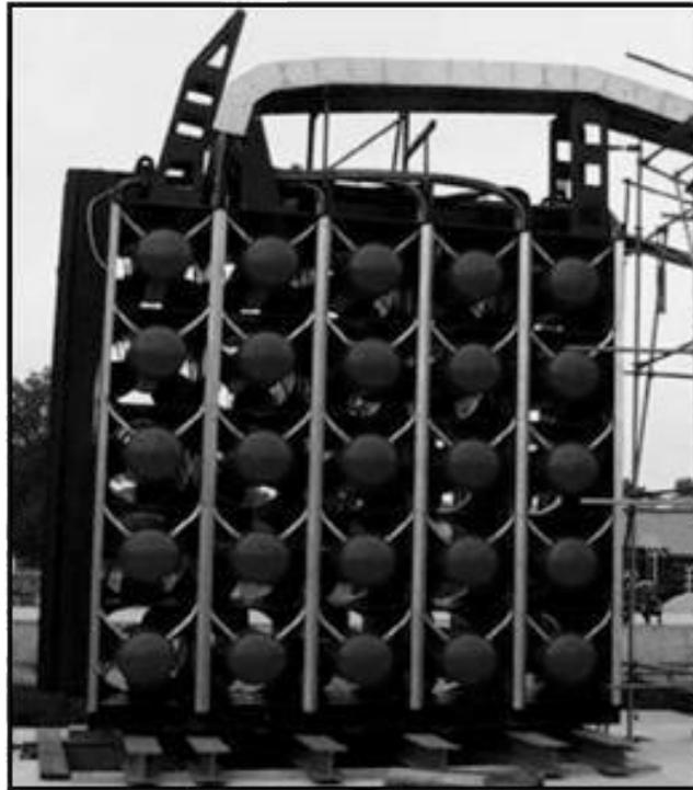
Figura 2.13. Vista de um sistema HYDROMATRIX antes de sua instalação em Freudenu, Áustria [26].
