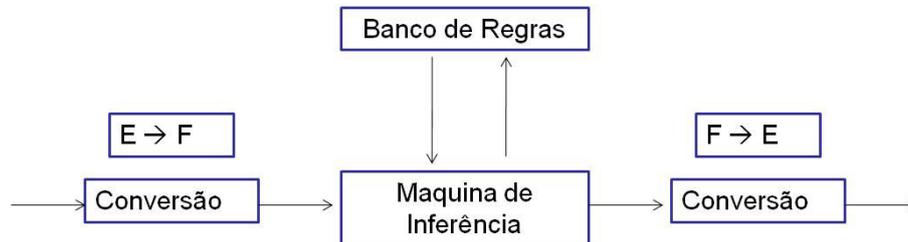
Figura 5.13 - Sistema de processamento nebuloso utilizando o método de inferência de Mamdani
