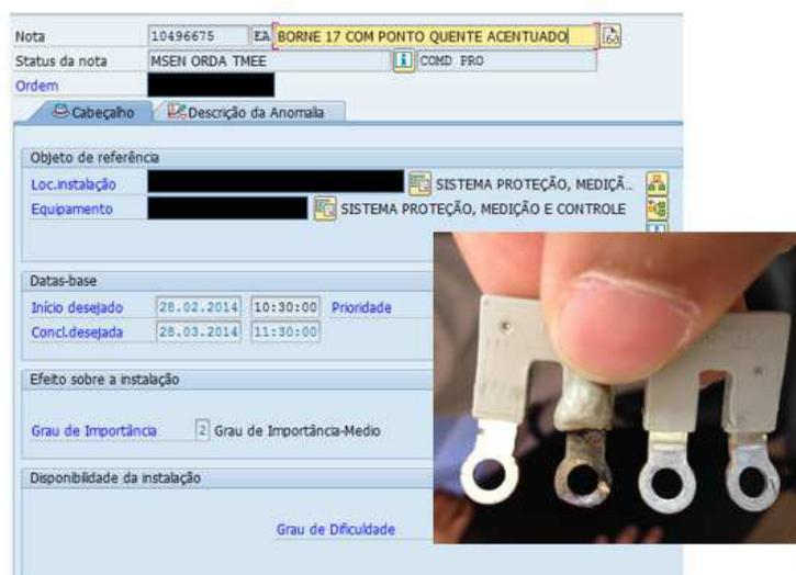
Figura 7.3 – Registro de anormalidade em conexão de um IED na SELI
