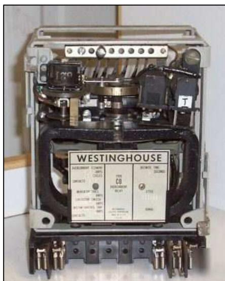
Figura 3.4 – Relé eletromecânico [42].
