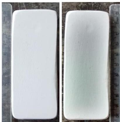
Figura 43: Demonstração da deformação dimensional no revestimento com fino de rochas. Fonte: Arquivo pessoal.
