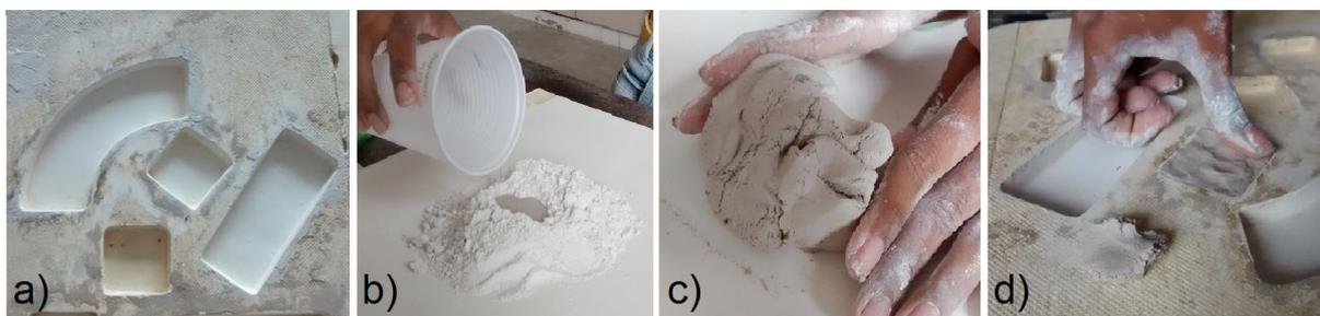
Figura 15: a) Molde do revestimento; b) Mistura com água; c) Amassamento da mistura; d) Preenchimento do molde. Fonte: Arquivo pessoal.
