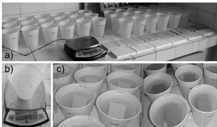
Figura 11: a) Preparação para identificação das massas imersas e úmidas; b) Pesagem; c) Corpos de prova submersos em água. Fonte: Arquivo pessoal.
