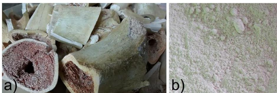
Figura 7: a) Ossos bovinos calcinados; b) Pó de ossos bovinos calcinados após peneiramento. Fonte: Arquivo pessoal.
