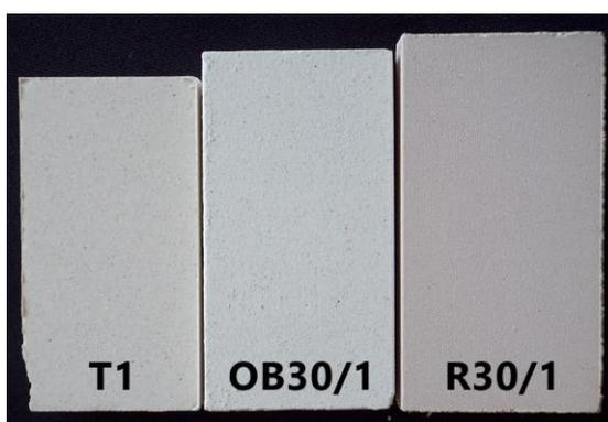
Figura 29: Diferentes retrações dos corpos de prova. Fonte: Arquivo pessoal.
