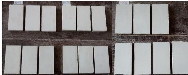
Figura 55: Corpos de prova de cerâmica branca com adição de fino de rochas após secagem. Fonte: Arquivo pessoal.
