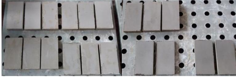
Figura 54: Corpos de prova de cerâmica branca com adição de fino de rochas ornamentais após conformação. Fonte: Arquivo pessoal.
