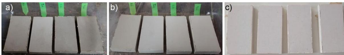
Figura 51: Corpos de prova de cerâmica branca triaxial: a) Após conformação; b) Após secagem; c) Após sinterização. Fonte: Arquivo pessoal.
