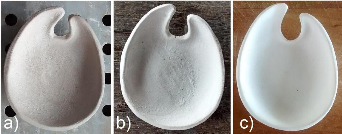
Figura 44: Petisqueira de cerâmica com ossos confeccionada por colagem de barbotina: a) Vista superior após conformação; b) Vista superior após queima; c) Vista superior após lixamento. Fonte: Arquivo pessoal.
