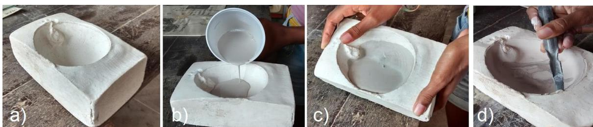
Figura 16: a) Molde poroso; b) Inserção de barbotina no molde; c) Aderência ao molde; d) Nivelamento das bordas. Fonte: Arquivo pessoal.
