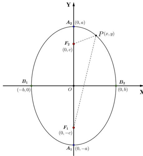
Figura 2.22: Eixo maior da elipse sobre o eixo das ordenadas
