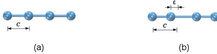
Figura 3.2: Estrutura de um nanofio linear (a) normal e (b) dimerizado.
