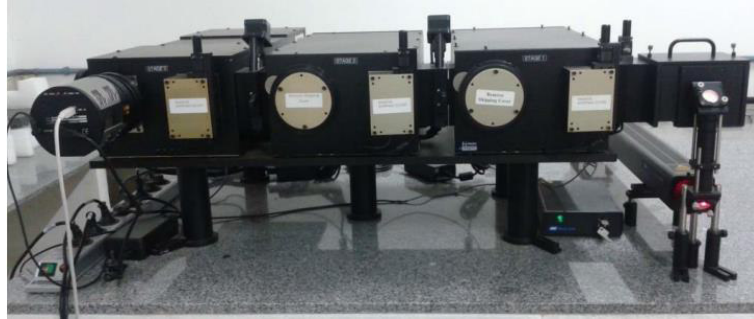
Figura 9. Espectrômetro Princeton TriVista 557 utilizado para as medidas de espalhamento Raman.
