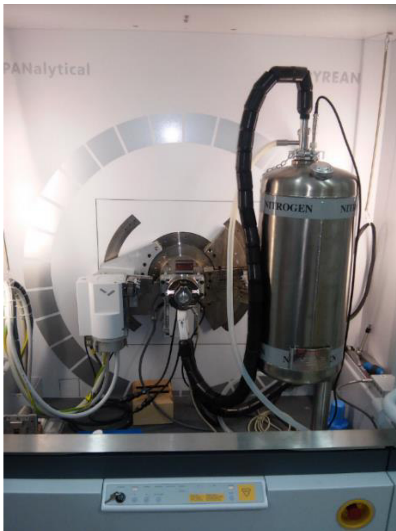
Figura 8. Visão global do difratômetro de raios-X da PANalytical com câmara de baixa temperatura TTK 450 acoplada.
