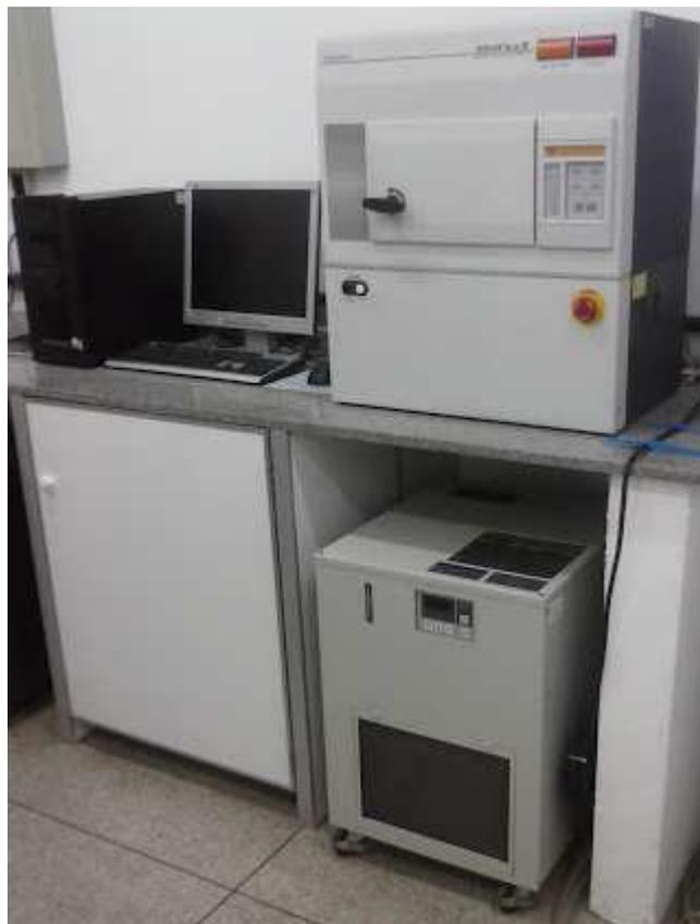
Figura 7 - Difratômetro Rigaku modelo miniflex II.
