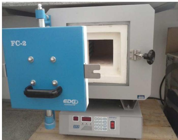
Figura 6 - Forno resistivo da EDG Equipamentos onde as amostras foram tratadas termicamente.
