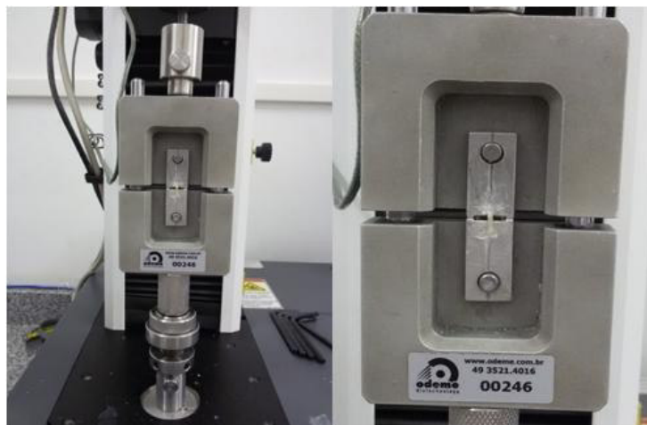
Figura 6. Ensaio de Microtração. (a) Máquina Universal Instron 3242 e (b) dispositivo de microtração onde o espécime é fixado e tracionado.
