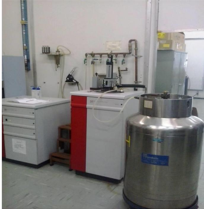
Figura 12 - Equipamento comercial MPMS utilizado para as medidas magnéticas das amostras.
