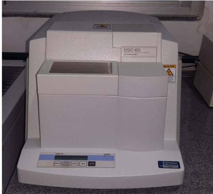
Figura 13 - Calorímetro Exploratório Diferencial usado para a varredura acima da temperatura ambiente no intuito de observar possíveis transições de fase.
