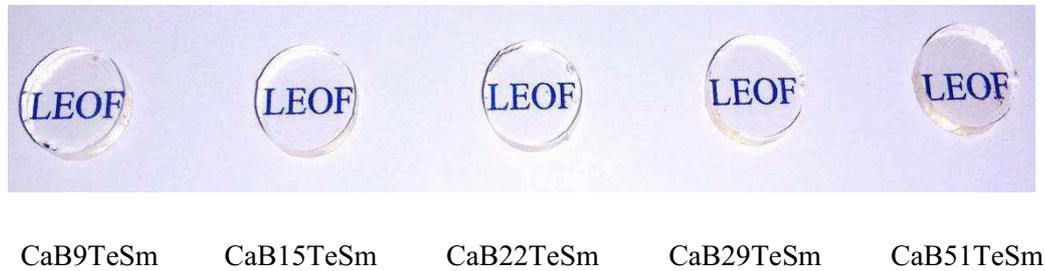
**Figura 8.** Foto das amostras  $\text{CaB}_x\text{TeSm}$  polidas para medidas ópticas.
