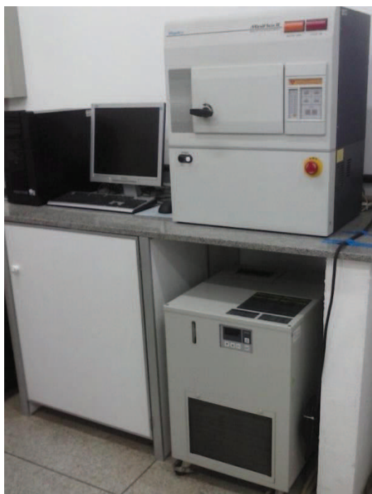
Figura 8: Difratorômetro Rigaku modelo miniflex II utilizado nas análises de difração de Raios X.
