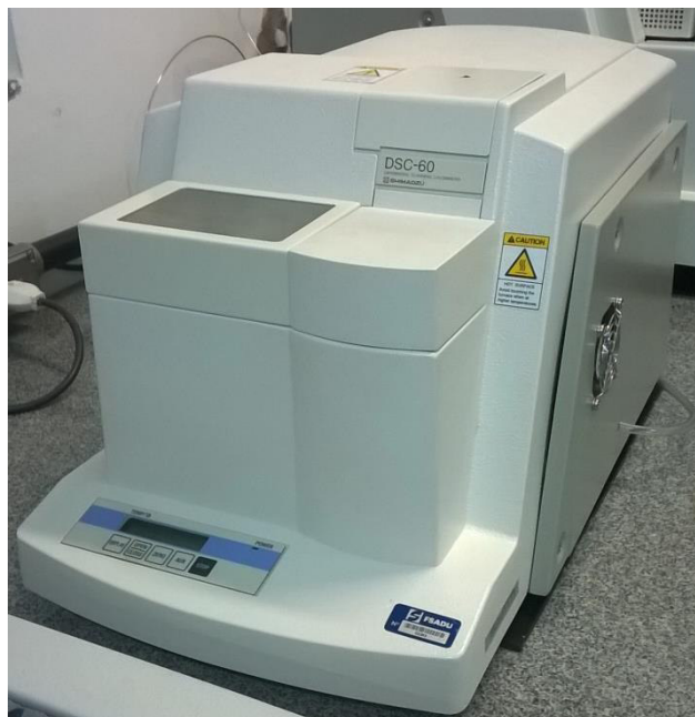
Figura 16 - Equipamento utilizado nos experimentos de análises térmicas: DSC 60 da SHIMADZU.
