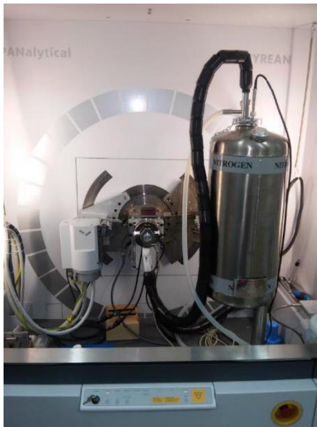
Figura 17 - Difratômetro de raios-X da PANalytical com câmara de baixa temperatura TTK 450 acoplada.
