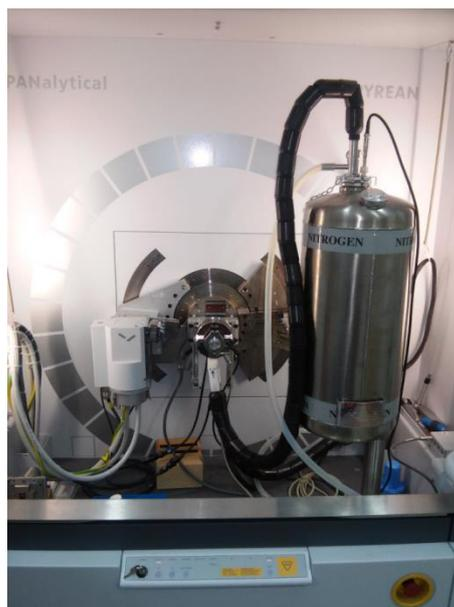
Figura 22 - Difratômetro de raios-X da PANalytical
