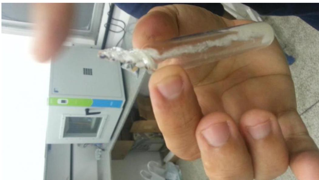
Figura 42 - L-Ile.HCl.H<sub>2</sub>O ressublimado.
