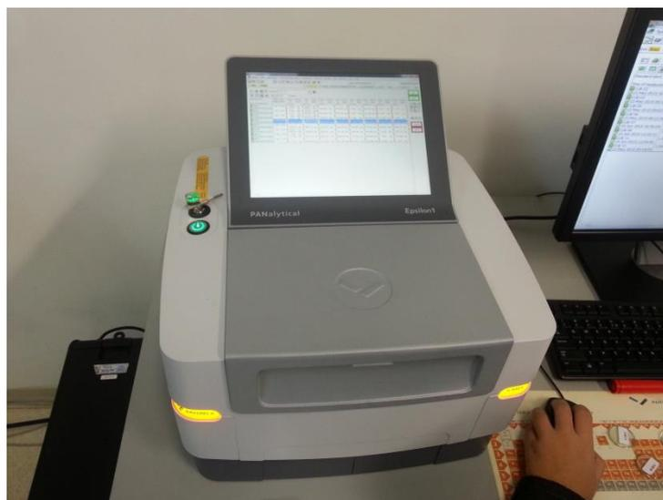
Figura 23 - Espectrômetro Epsilon 1 da PANalitical
