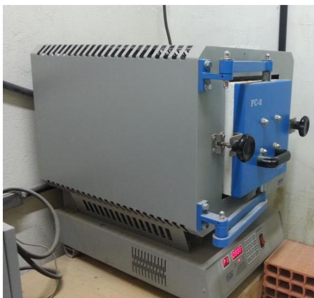
Figura 25 – Forno tipo Mufla utilizada no tratamento térmico de L-Ile.HCl.H<sub>2</sub>O
