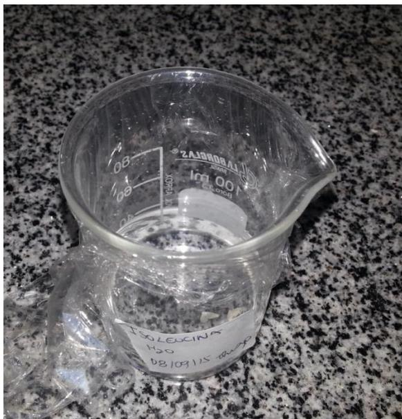
Figura 28 - Becker para síntese do cristal por evaporação lenta do solvente.
