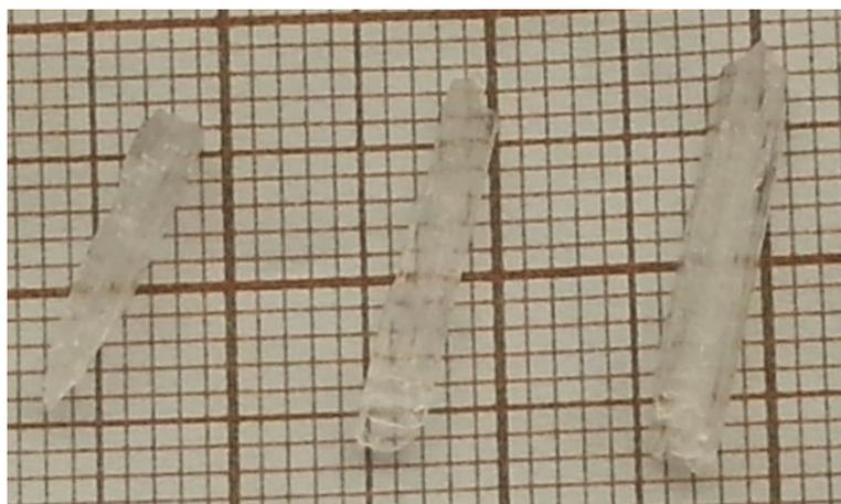
Figura 29- Cristal de L-Ile.HCl.H<sub>2</sub>O
