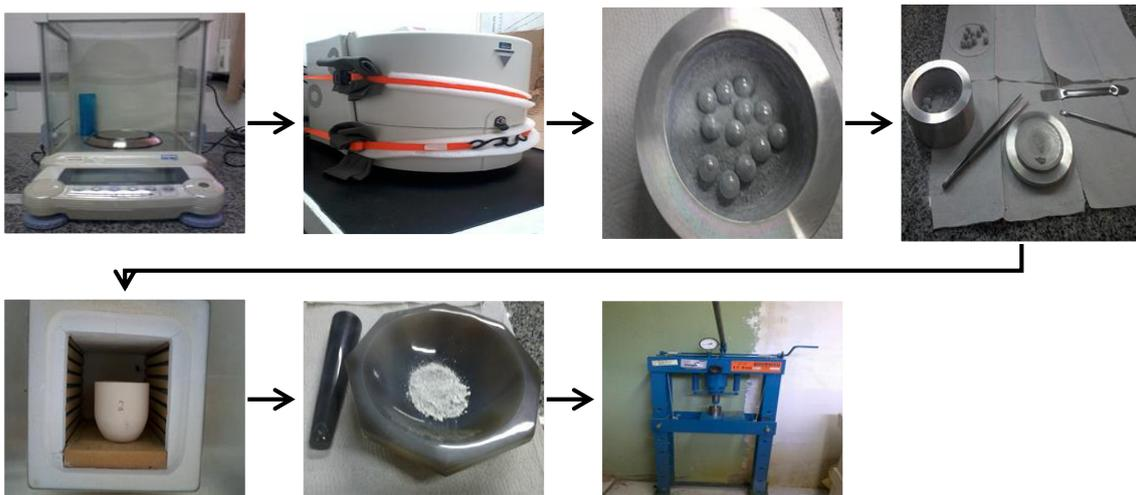
Figura 7-Fluxograma de Síntese do CaTiO<sub>3</sub> e CaTiO<sub>3</sub> Substituído
