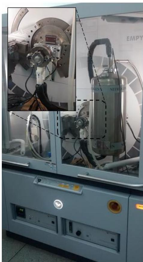
**Figura 17** – Difratômetro utilizado com detalhe para a câmara de temperatura TTK 450 acoplada.
