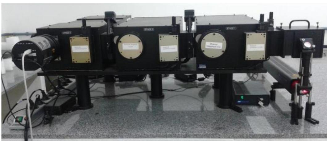
**Figura 15** – Espectrômetro utilizado para as medidas de Espalhamento Raman.
