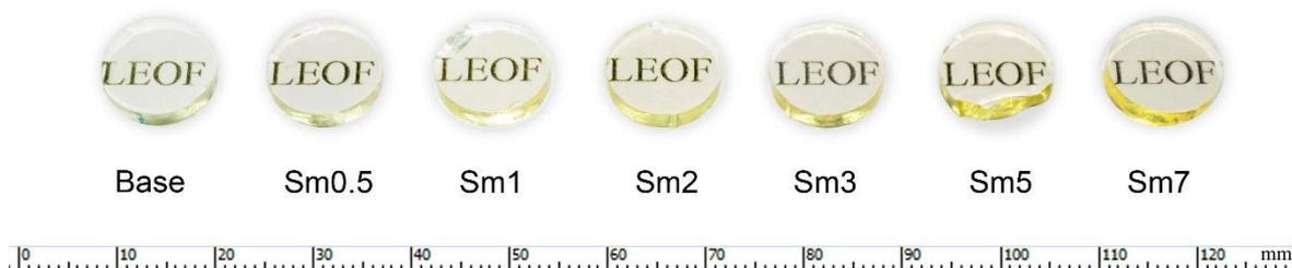
Figura 21. Vidros CaAl dopados com  $\text{Sm}_2\text{O}_3$ .
