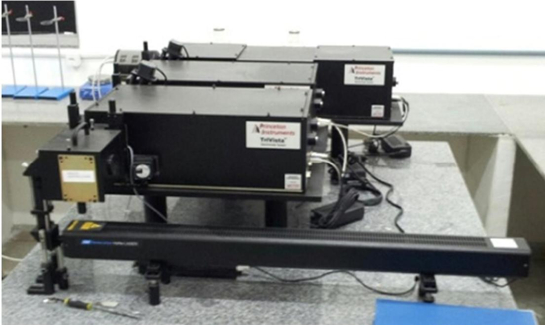
**Figura 2.4: Espectrômetro Raman *Pricenton Instruments* com *Laser HeNe* de 75mW e comprimento de onda de 632,8 nm**
