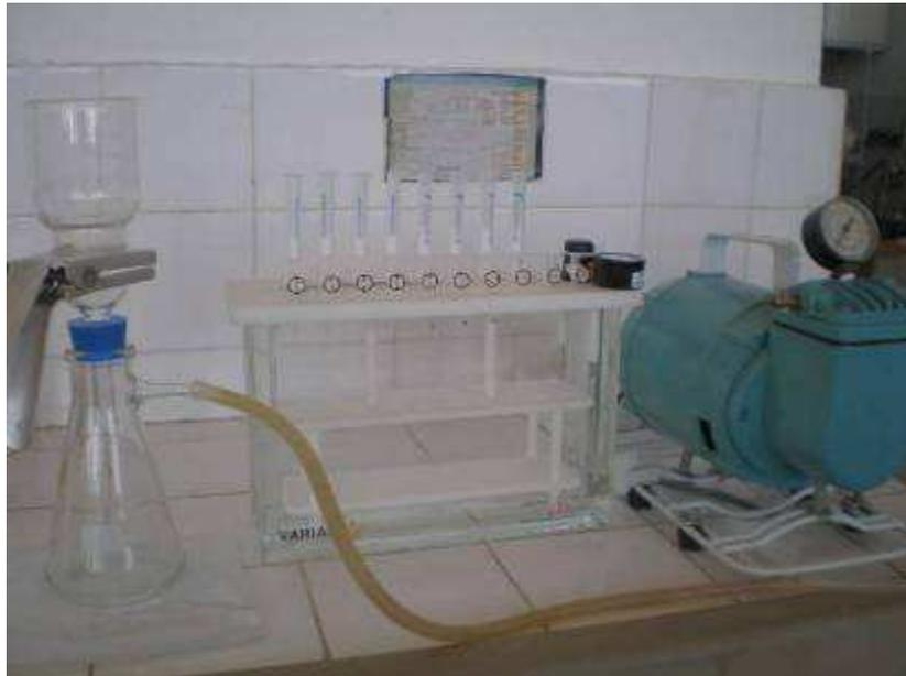
Figura 8: Filtragem e extração em fase sólida das amostras, empregando cartuchos de polipropileno C<sub>18</sub> e CN.
