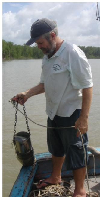
**FIGURA 3.14 – Draga de Gibbs para coleta de sedimento de fundo**
