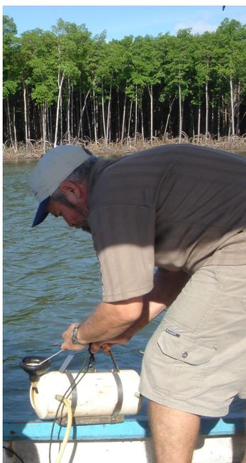
**FIGURA 3.13 – Garrafa de van Dorn para coleta de água a diferentes profundidades**
