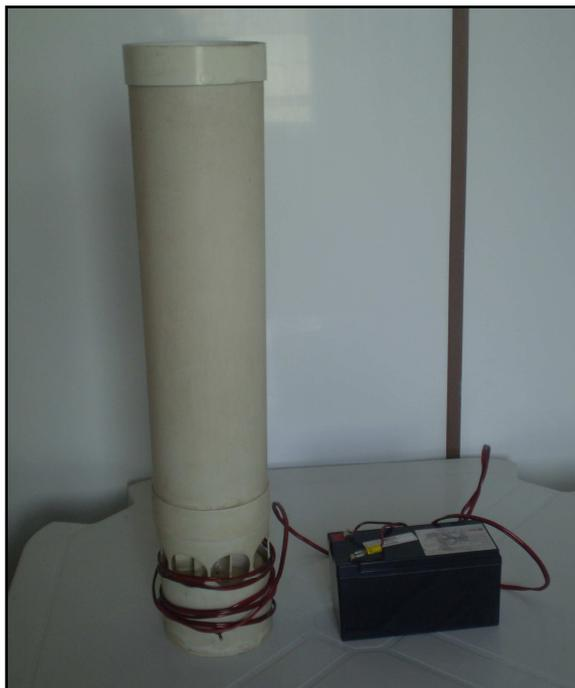
**Figura 3.** Aspirador mecânico acoplado à bateria, utilizado na captura de alados do *A. aegypti*.
